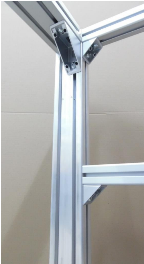
Abbildung 10 SMS-I-40x80: Beispiele zur Verbindung Hubelement mit Grundrahmen mittels handelsüblicher Anbindungswinkel (klein/groß)
