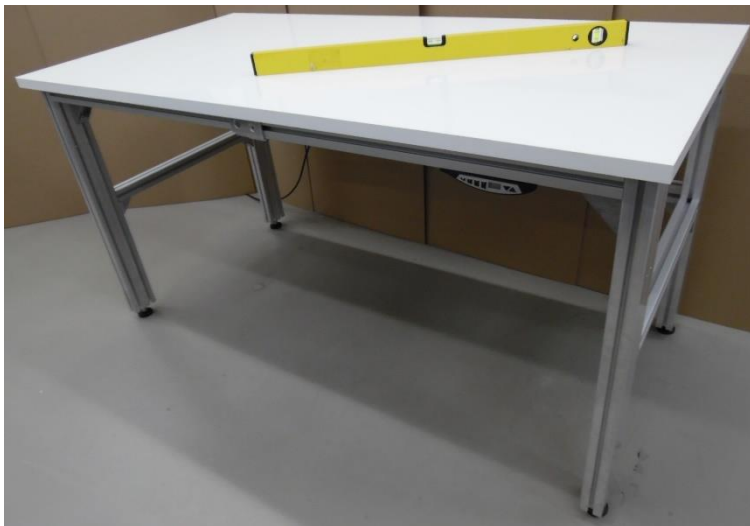
Abbildung 25 Einstellen des Arbeitsplatzes mit Wasserwaage
