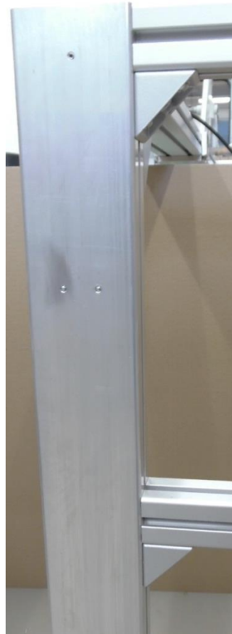
Abbildung 10 SMS-I-40x80: Beispiele zur Verbindung Hubelement mit Grundrahmen mittels handelsüblicher Anbindungswinkel (klein/groß)
