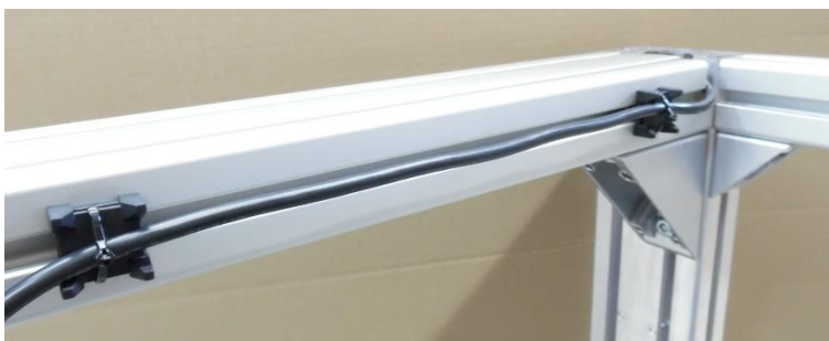
Abbildung 23 Kabelführung mit Kabelhaltern
