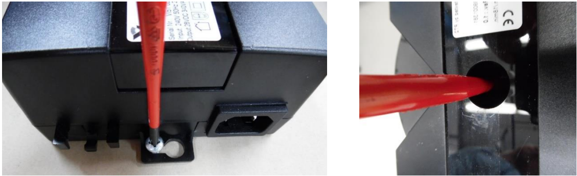
Abbildung 15 Befestigung der elektrischen Steuerung (Schraubenanbindung: links 3x, rechts 1x)
