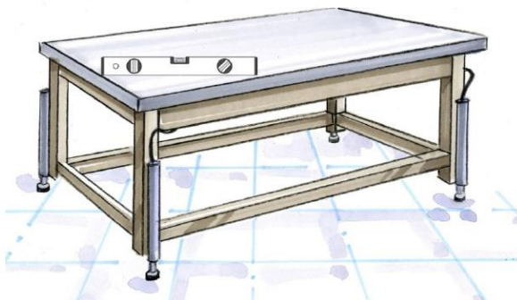
Abbildung 19 Einstellen des Arbeitsplatzes mit Wasserwaage
