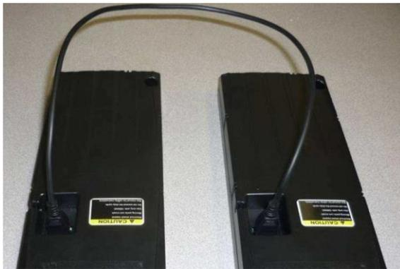
Abbildung 31 Verbindung zwischen zwei Motorsteuerungen
