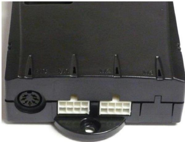
Abbildung 28 Anschlussbuchsen der Motorsteuerung
