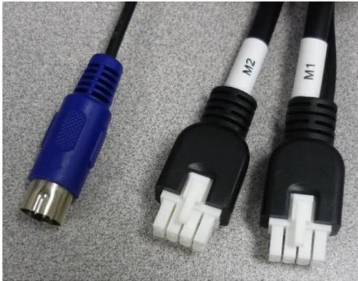
Abbildung 29 Anschlussstecker der Motorsteuerung
