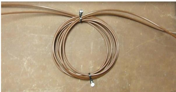
Abbildung 33 Aufwickeln von Hydraulikschläuchen
