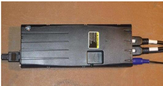
Abbildung 30 Anschlüsse der Motorsteuerung
