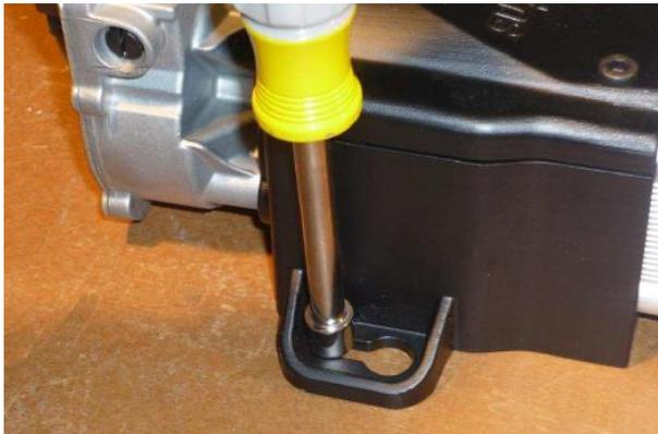
Abbildung 14 Montage der Befestigungselemente für die Motorhalterung
