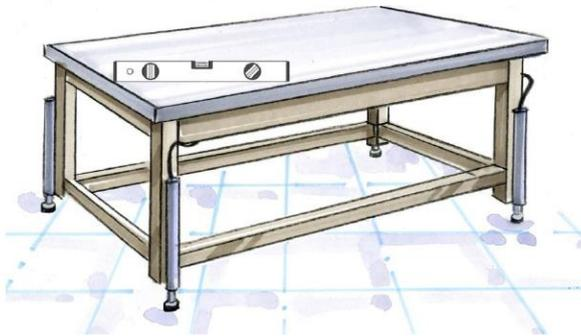
Abbildung 34 Einstellen des Arbeitsplatzes mit einer Wasserwaage
