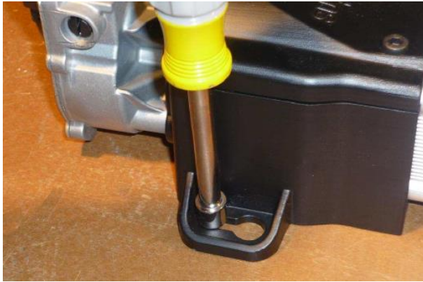
Abbildung 14 Montage der Befestigungselemente für die Motorhalterung
