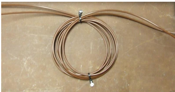
Abbildung 33 Aufwickeln von Hydraulikschläuchen
