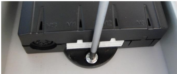
Abbildung 17 Befestigung der Motorsteuerung
