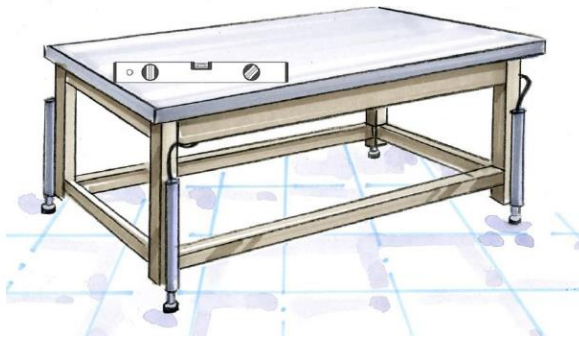
Abbildung 34 Einstellen des Arbeitsplatzes mit einer Wasserwaage
