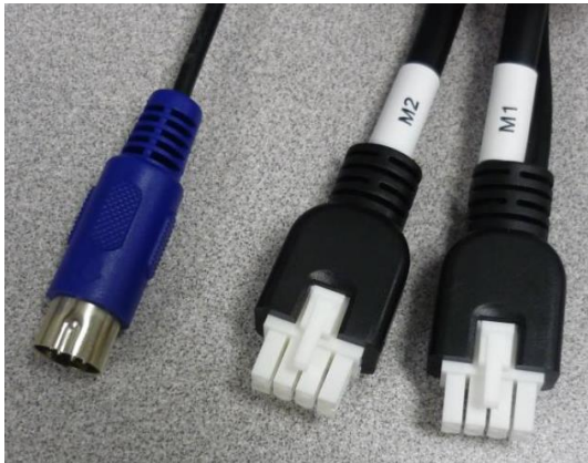
Abbildung 29 Anschlussstecker der Motorsteuerung
