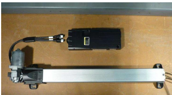
Abbildung 16 Anbringen der Motorsteuerung
