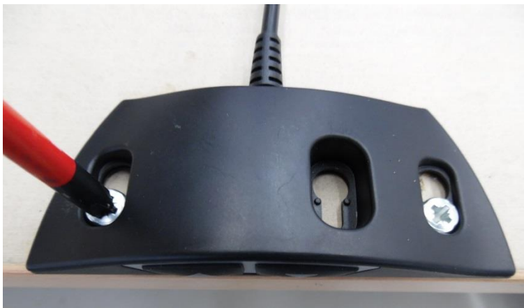
Abbildung 12 Befestigung des einfachen Handschalters UBM-F/2-p
