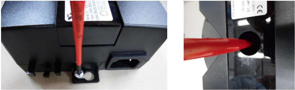
Abbildung 10 Befestigung der elektrischen Steuerung (Schraubenanbindung: links 3x, rechts 1x)
